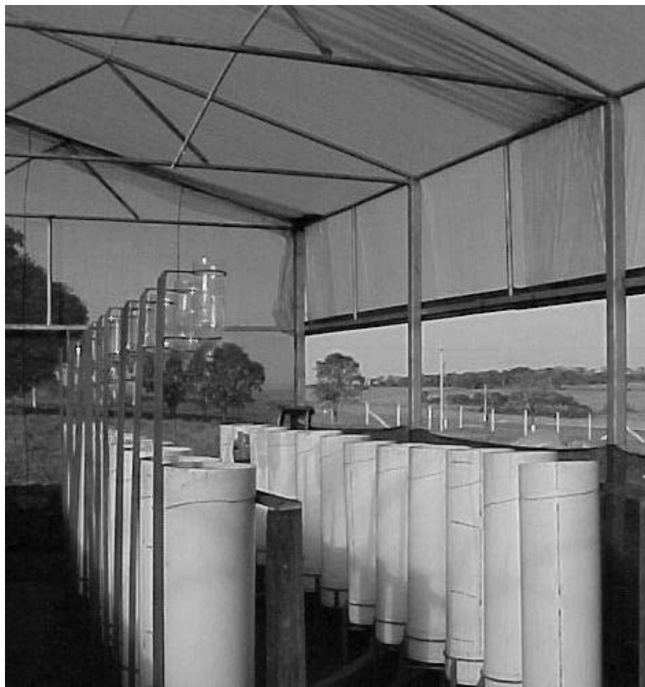
FIGURA 1. Visão ampla do local do experimento para avaliar o potencial de contaminação de águas residuárias de suinocultura, enfocando as duas baterias constituídas por 24 lisímetros
